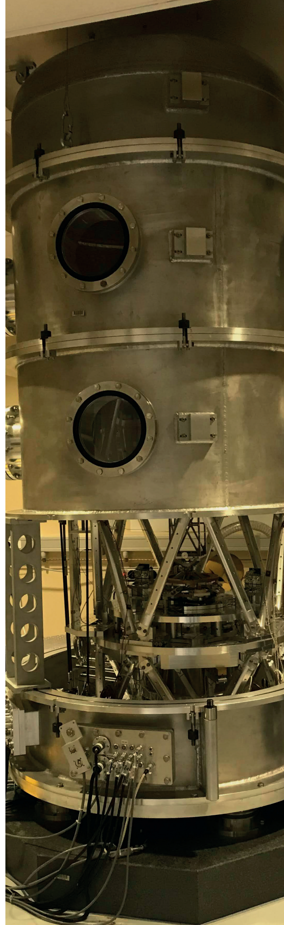
La balance de Kibble du BIPM, qui a servi à « réaliser » le kilogramme.
